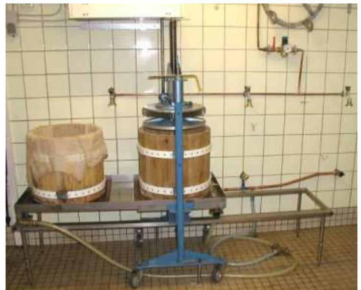
**Foto 2: Spindelkorbpresse** mit Motorantrieb und 2 x 50 Liter Presskörben in Schiebbetrieb. Der Pressraum wurde 1993 eigens für den Betrieb dieser Presse gebaut und ausgelegt. Davor wurde die Presse unter dem Hofdach im Freien betrieben.
