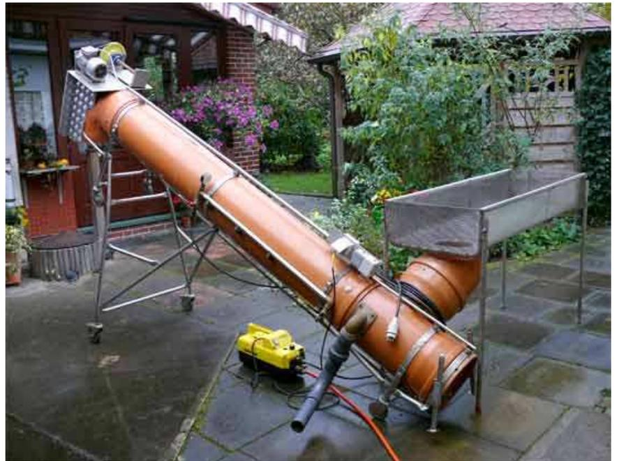
**Foto 6: Obstwaschanlage** mit Obstwaschmaschine „Heuschrecke“, Hochdruckreiniger und Obsteinlaufwanne. Am unteren Förderweg der Heuschrecke ist der Düsenstock mit 3 Wasserstrahldüsen der Firma Kärcher angeordnet. Der Wasserdruck ist am Hochdruckreiniger stufenlos einstellbar und kann am Hydrometer des Düsenstockes abgelesen werden.
