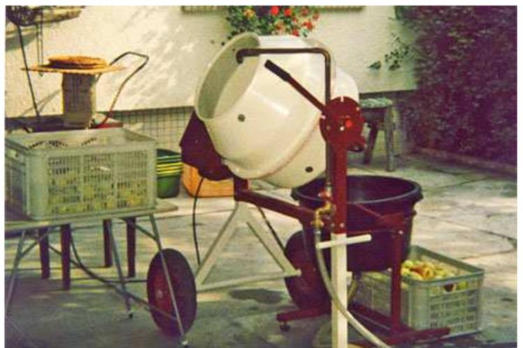
**Foto 5: Betonmischer als Obstwaschmaschine** mit Bütt als schwenkbares Stufenbecken mit unterem Wasserablauf. Leistung: 120 Kg/Stunde, hoher Wasserverbrauch.
